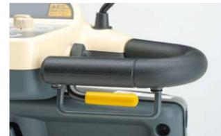
アクセルレバー [握り込み停止機能付] レバーを握ると発進 (前進・後進) し、放すと自動的にブレーキがかかります。また、強く握り込むと緊急停止します。
