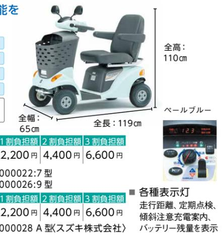
各種表示灯 走行距離、定期点検、傾斜注意充電案内、バッテリー残量を表示
